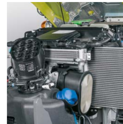
Het PowerCore®-luchtfilter beschikt over langere reinigingsintervallen en is eenvoudig toegankelijk aan de voorzijde onder de motorkap.
