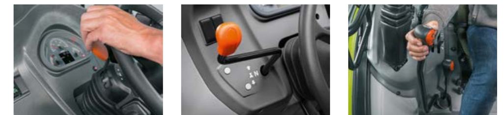
De omkeerschakeling bevindt zich binnen handbereik links naast het stuurwiel, naar keuze elektronisch met de REVERSHIFT of mechanisch.
