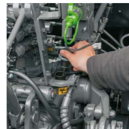
Je controleert gewoon het oliepeil van de transmissie en de hydrauliek aan de achterkant.
