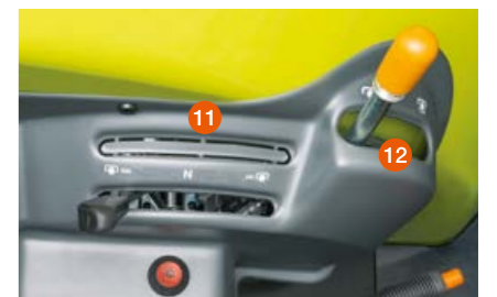
De aftakas wordt standaard hydraulisch bekrachtigd ingeschakeld. Bij machines met REVERSHIFT uitrusting is een elektronisch geschakelde aftakas achter als optie leverbaar.
