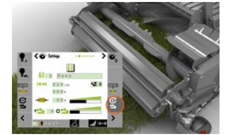
Het POWER FEEDING SYSTEM kan eenvoudig direct vanuit de cabine worden teruggedraaid.
