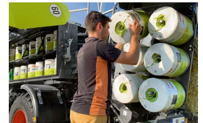
Ruimte voor 12 extra touwrollen optie. Afhankelijk van de omvang van de touwrollen is dat voldoende voor 350-400 pakken.
