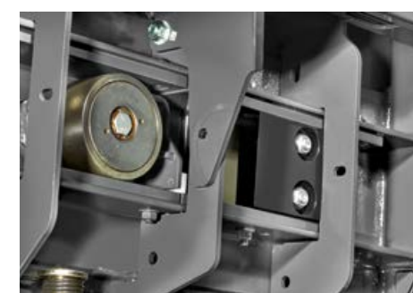
De draaibare messen kunnen in twee standen worden aangebracht voor gebruik in stro/maïsstro of hooi/silage.
