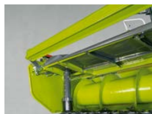
Aandrukrollen voor een zeer gelijkmatige gewasstroombewerking.
