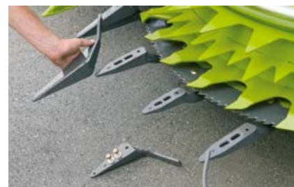
Demonteerbare invoeringsers verbeteren de opname van liggend maïs.
