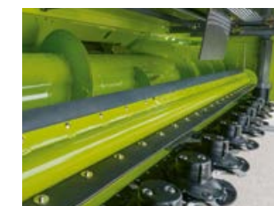
DIRECT DISC 600 P/500 P met in hoogte verstelbare peddelwals, hydraulische bedieningsoptie.
