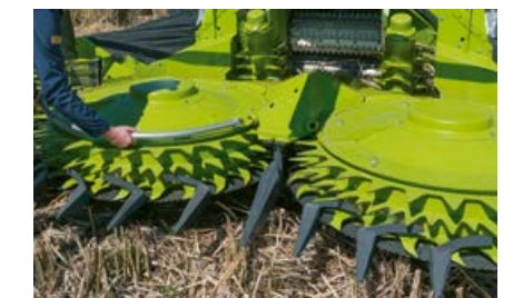
Demontage van de kolvenopvang verhoogt doorstroming van het gewas
