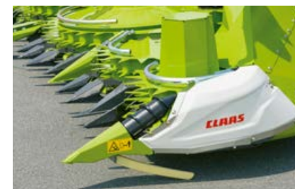
Hydraulisch aangedreven torpedo's voor liggend maïs
