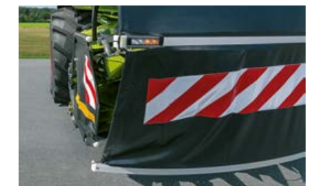
De beschermingslijst aan de voorzijde en de zijdelingse beschermingen zijn dankzij waarschuwingsstickers goed zichtbaar. Volledig geïntegreerde led-verlichting.
