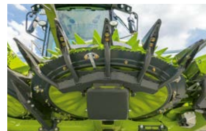
Robuuste geleidevingers en schrapers onder de messchijven voor schone werking.
