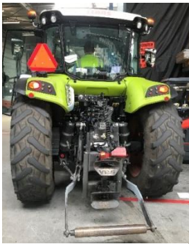
Aangepaste verlengde trekhaak en de disselrol in de hefarmen.
