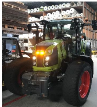
Voor de veiligheid is voorop LED-signaalverlichting gemonteerd.
