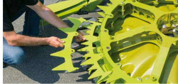
Gesegmenteerde opbouw van transport- en messenschijven
