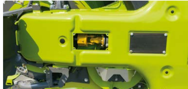
Eenvoudige toegang tot de koppelingen door servicekappen
