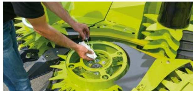
Geïntegreerde oliepeilstok voor het controleren van het olieniveau
