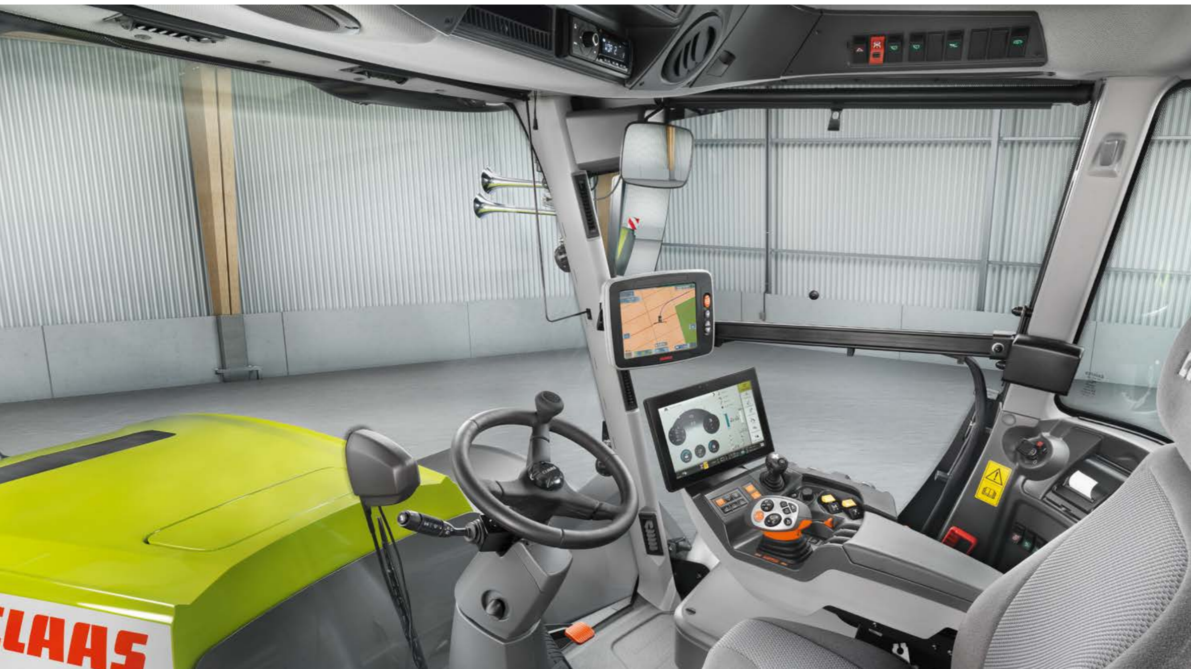
De TRAC VC heeft het meest comfortabele achteruitrijrichting op de markt. Zijn cabine kan in minder dan 30 seconden 180 ° worden gedraaid.
