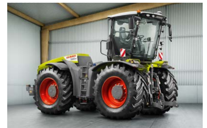
De TRAC VC heeft het meest comfortabele achteruitrijrichting op de markt. Zijn cabine kan in minder dan 30 seconden 180 ° worden gedraaid.
